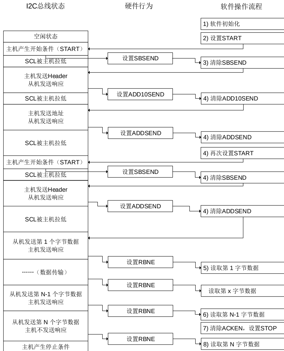
图 20-12. 主机接收使用方案 A 模式（10 位地址模式）
